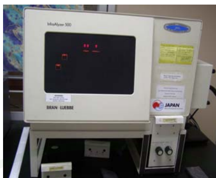
ภาพผนวกที่ ก6 เครื่อง Near Infrared Spectroscopy (BRAN + LUEBBE, InfraAlyzer 500, Norderstedt, Germany)
