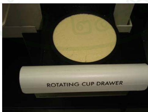
ภาพผนวกที่ ก5 นำตัวอย่างที่ผ่านการปั่นบรรจุลงใน rotating cup ก่อนทำการวิเคราะห์ ด้วยเครื่อง NIR
