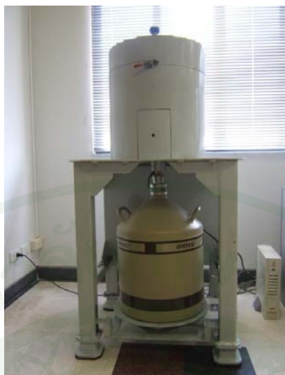
ภาพที่ 15 แสดงรูปตัวตรวจหารังสีแกมมาเจอร์มาเนียมบริสุทธิ์สูงที่ใช้ในการวัด
