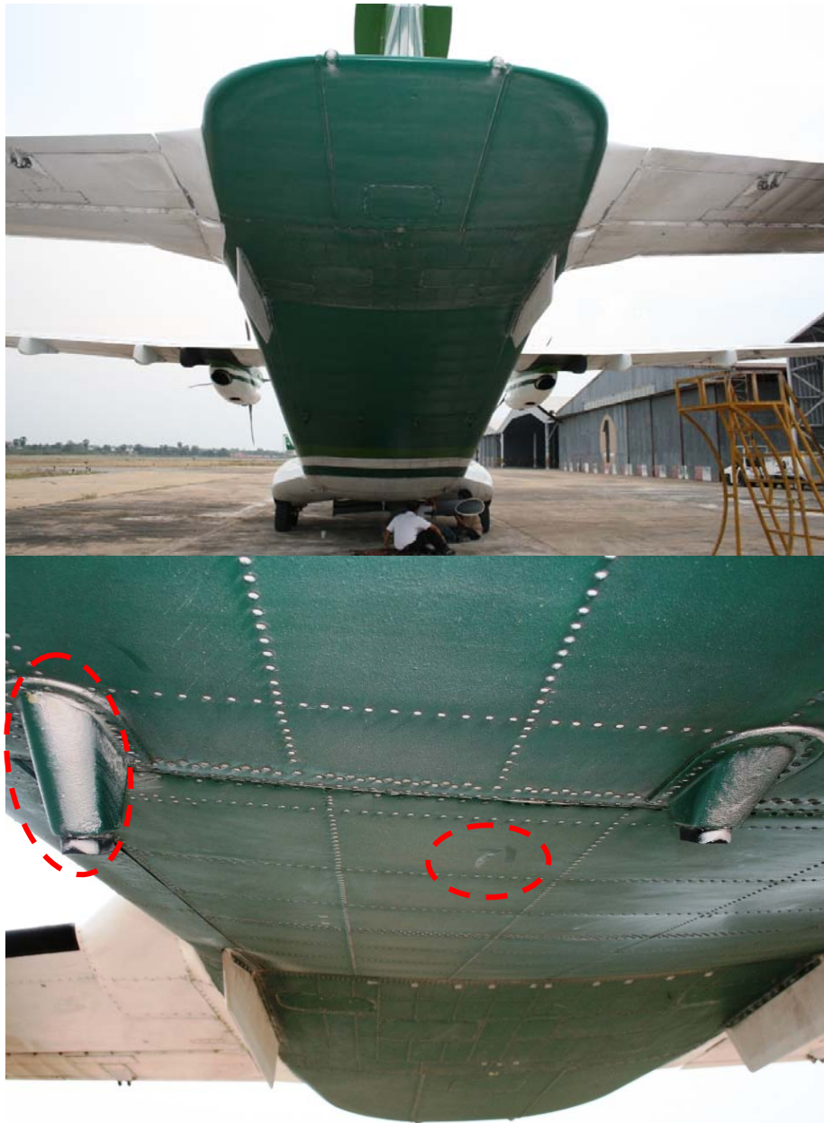
รูปที่ 4.5: ภาพถ่ายเบื้องหลังเครื่องบินซีเอ็น 235 พร้อมท่อโปรยสารต้นแบบ (บน) และภาพถ่ายขยายที่แสดงฝนสีขาวของสารฝนหลวงที่สะสมอยู่บนพื้นผิว (ล่าง)
