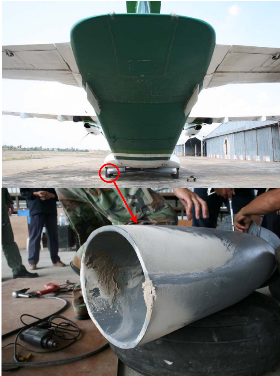
รูปที่ 4.4: ภาพถ่ายเบื้องหลังเครื่องบินซีเอ็น 235 พร้อมท่อโปรยสารตัดแปลงแบบที่ 3 (บน) และภาพถ่าย ปลายท่อเดียวกัน (ล่าง) แสดงให้เห็นสารฟนหลวงสีขาวที่สะสมบริเวณด้านหลังท่อ
