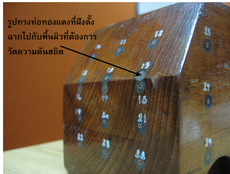
รูปที่ 4.1: ตัวอย่างพื้นผิวที่ถูกฝังด้วยท่อวัดความดันสถิตที่ทำจากท่อทองแดง
