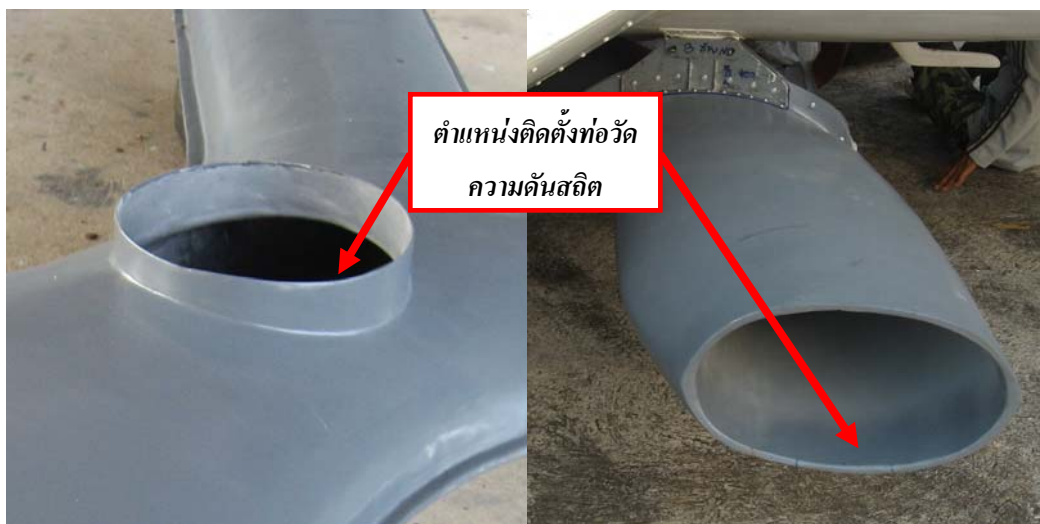
รูปที่ 4.2: แสดงตำแหน่งติดตั้งท่อวัดความดันสถิตที่ส่วนกลางท่อโปรยสารและปลายท่อโปรยสาร
