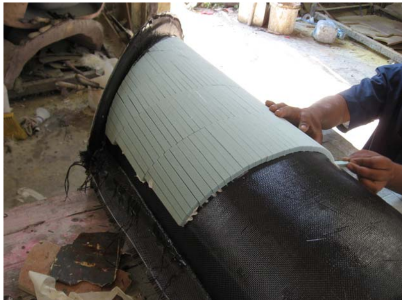
รูปที่ 3.11 แสดงการเรียงโฟมพีวีซีทับบนเส้นใยคาร์บอนชั้นใน
