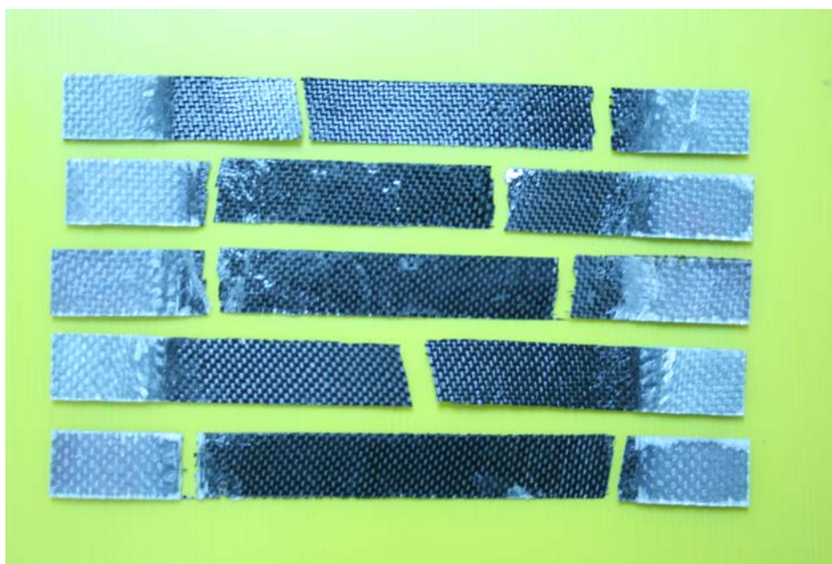
รูปที่ 3.4: ชิ้นงานแผ่นคาร์บอนที่ผ่านการทดสอบจนกระทั่งเสียหาย
