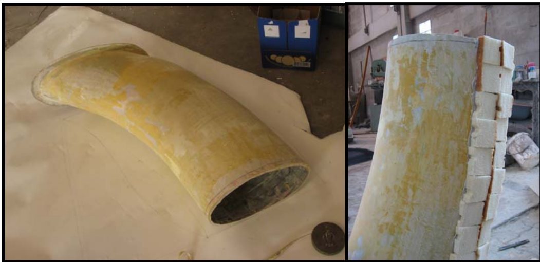
รูปที่ 3.10: การสร้างแม่พิมพ์ส่วนของปลายท่อรูปตัววาย (Y-tube) ตามแบบปรับปรุง แบบที่ 2 (ท่อโค้ง) และ 3 (ท่อโค้งมีปลอกหุ้ม)
