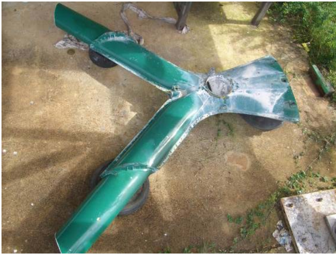
รูปที่ 1.1: (ซ้าย) แสดงท่อปล่อยสารฝนหลวงที่จะถูกนำไปติดตั้งที่ห้องเติมตัว (ดนตรี และ พจนนัท, 2551) และ (ขวา) ส่วนทางเข้าสารฝนหลวง
