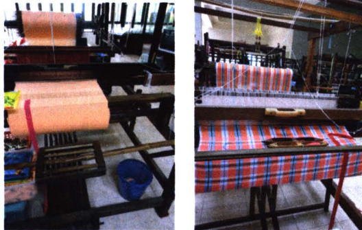
ภาพที่ ๓.๒ แสดงรูปแบบเดิมของที่ม้วนเก็บผ้าที่ทอ
