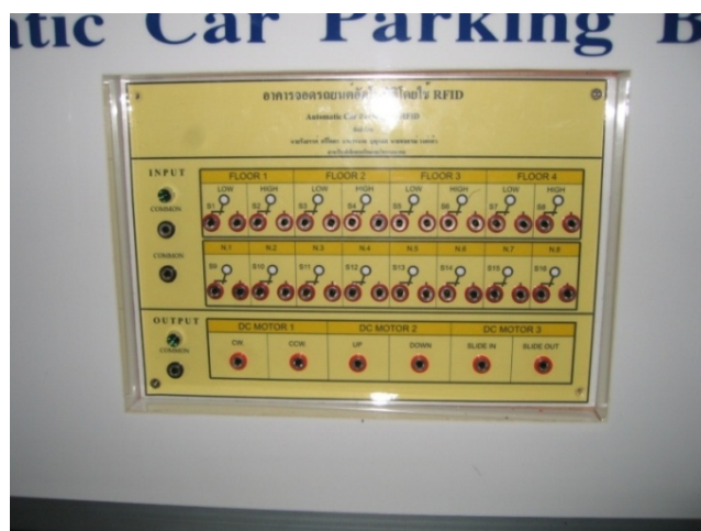
รูปที่ 3.27 แผงควบคุมสำหรับเชื่อมต่อ PLC กับมอเตอร์และเซ็นเซอร์
