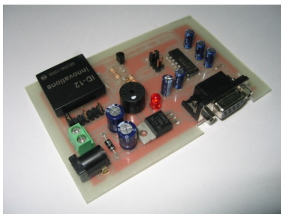
รูปที่ 3.4 ภาพจริงของวงจร RFID Reader
