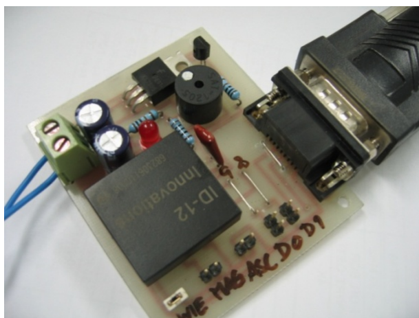
รูปที่ 3.6 ภาพจริงของวงจร RFID Reader อย่างง่าย
