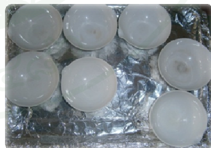
นำถ้วยกระเบื้องไปอบเพื่อหาไขมันและน้ำมัน
