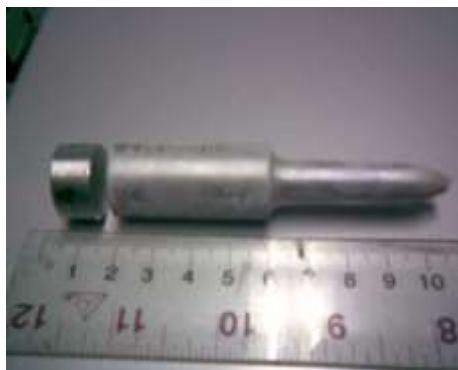
รูปที่ 3.17 ชิ้นงานสำหรับการศึกษาผลของการขัดผิวตัวอย่างที่มีต่อการวัดสัมประสิทธิ์ซีเบ็ค
