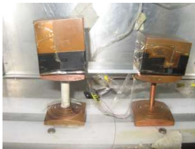
รูปที่ 3.5 อุปกรณ์สำหรับวัดสัมประสิทธิ์ซีเบ็คในแนวนอน
