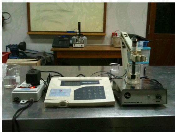
ภาพที่ 18 การวัดค่าศักย์ไฟฟ้าด้วยขั้วไฟฟ้าเลือกจำเพาะซิลเวอร์ซัลไฟด์
