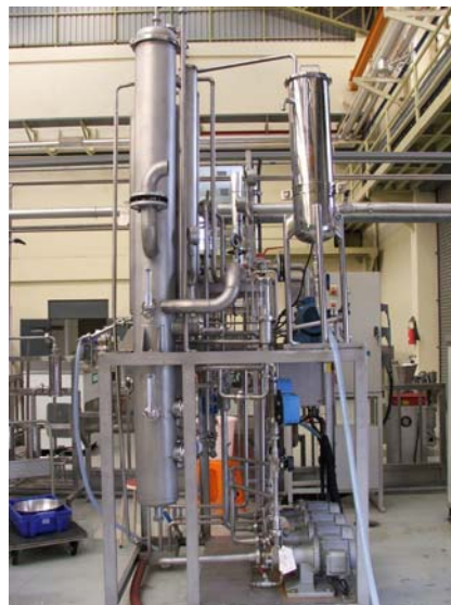
รูปที่ 3.3 เครื่องต้มระเหยแบบฟิล์มเคลื่อนที่ลง (Falling Film Evaporator)
