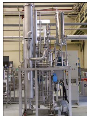
รูปที่ 3.9 เครื่องต้มระเหยแบบฟิล์มเคลื่อนที่ลง
