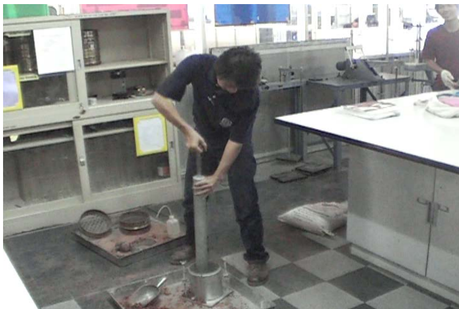
รูปที่ ข.11 การถ่ายทำวิดีโอในขั้นตอนการทดสอบการบดอัด และการทดสอบ C.B.R.
