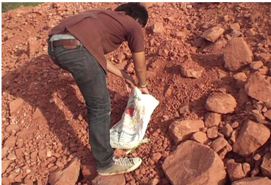
รูปที่ ข.9 การเก็บตัวอย่างดินลูกรังมาทดสอบ
