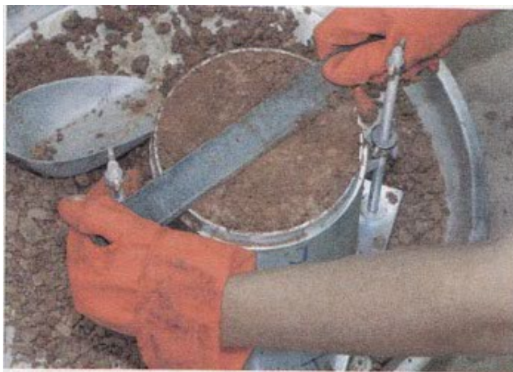
รูปที่ ก.28 ใช้เหล็กปาดดินที่เกินออก
