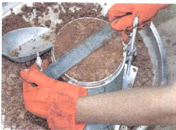
รูปที่ ก.6 ใช้เหล็กปาดแต่งผิว
