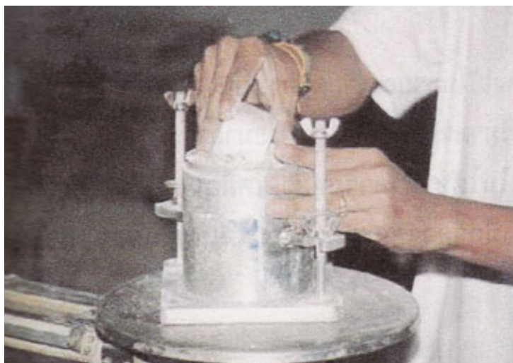
รูปที่ ก.24 เก็บตัวอย่างดินใส่ตลับบรรจุดิน
