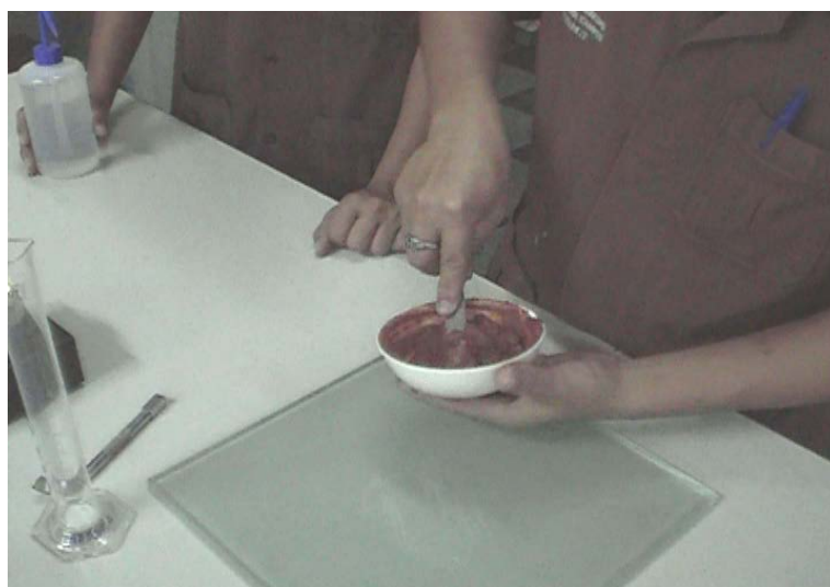
รูปที่ ก.14 เติมน้ำกลั่นลงในดินและกวนให้เป็นเนื้อเดียวกัน
