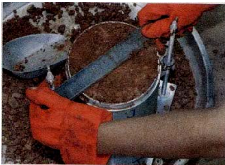
รูปที่ ก.22 ใช้เหล็กปาดแต่งผิว
