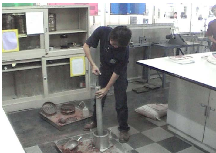
รูปที่ ก.5 ใช้ตุ้มบดอัดให้แน่น
