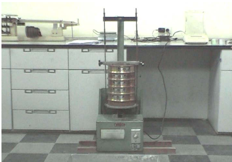
รูปที่ ก.2 การเขย่าตะแกรง
