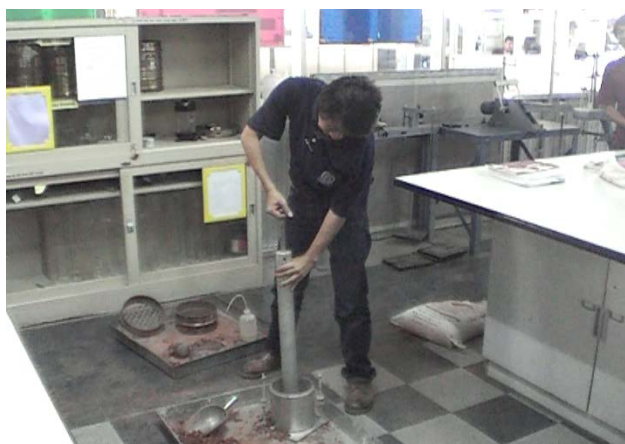
รูปที่ ก.21 ใช้ค้อนบดอัดให้แน่น
