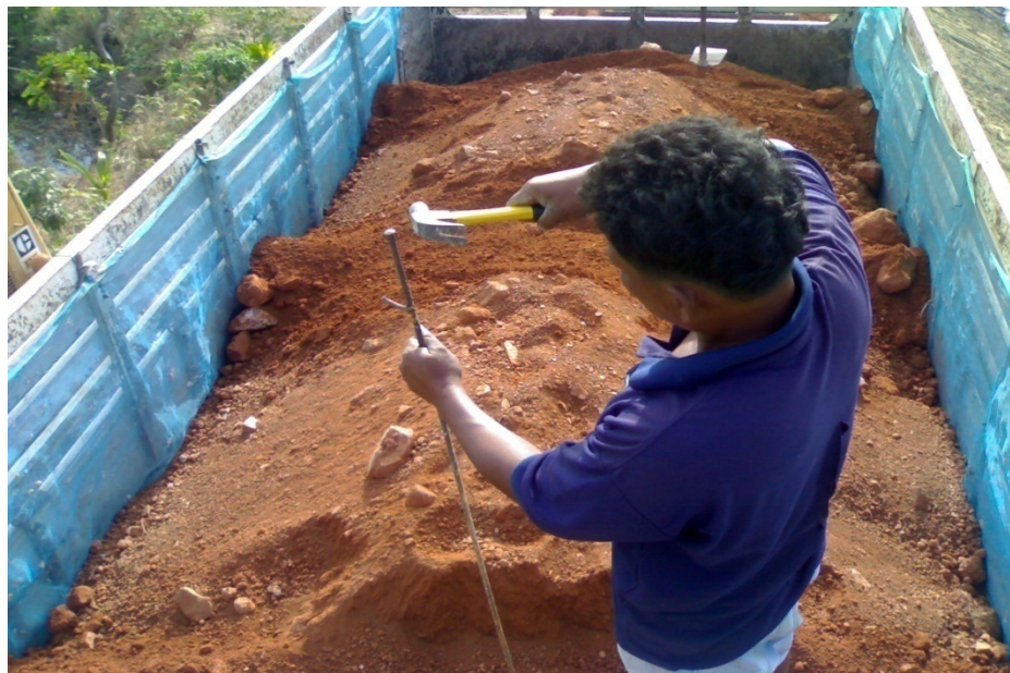
รูปที่ 37 การตอกเหล็กส่วนพื้นที่แรกของกระบะ
