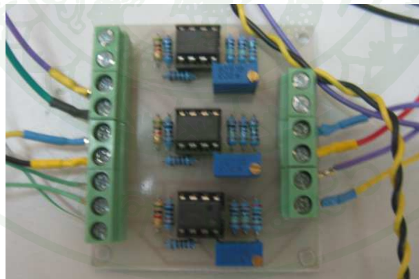
ภาพที่ 57 การต่อวงจรแปลงเป็น \pm 10 โวลต์เป็น 4-20 มิลลิแอมป์
