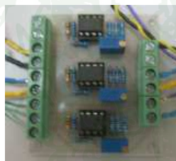
ภาพที่ 13 วงจรแปลงสัญญาณ +/- 10 โวลต์เป็น 4-20 มิลลิแอมป์
