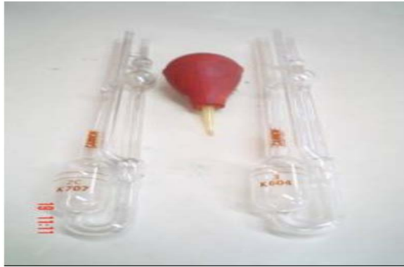
รูปที่ 2.4 อุปกรณ์วัดความหนืด [16]
