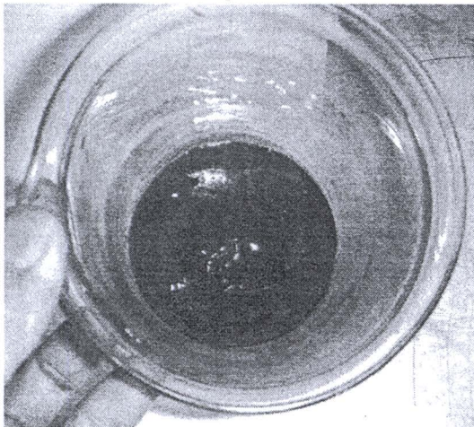
รูปที่ 3.126 ตะกอนโคลนที่ผ่านกระบวนการแยกสลาย
