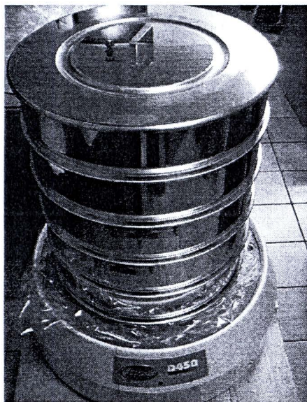
รูปที่ 3.66 เครื่องคัดขนาดโลหะผงทั้งสแตนคาร์ไบด์
