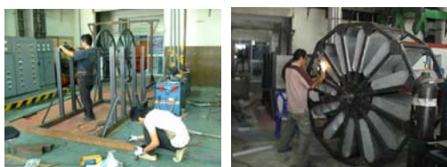
รูปที่ 29 ผู้ช่วยนักวิจัย ประกอบวงล้อน้ำและฐาน ตามแบบ ในห้องทดลอง มหาวิทยาลัยเทคโนโลยีราชมงคลธัญบุรี เขตพื้นที่ภาคพายัพ เชียงใหม่
