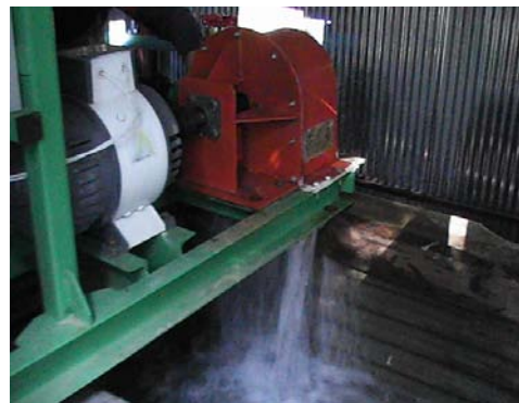
รูปที่ 19 นักวิจัยทดลองเดินเครื่อง กังหันน้ำภายในทำโรงเก็บ
