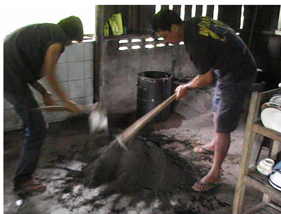
รูปที่ 176 เตรียมผสมดิน ทราช ปูน เพื่อขึ้นรูปลำตัวเตาไร่ควัน
