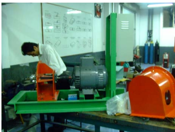
รูปที่ 81 ประกอบและติดตั้งห้องกังหันที่ออกแบบพัฒนาใหม่
