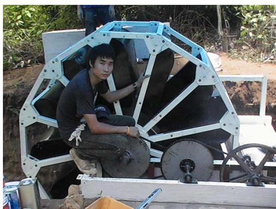
รูปที่ 223 ปรับตั้งหูเฟืองโซ่และสายพานส่งกำลัง
