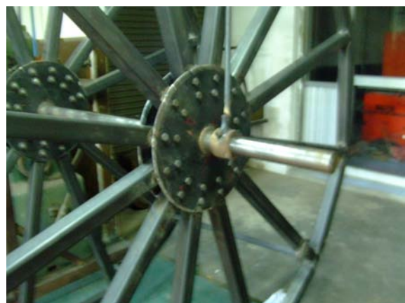
รูปที่ 190 การยึดโครงถอดประกอบจาก Bolt และ Nut จำนวนมาก
