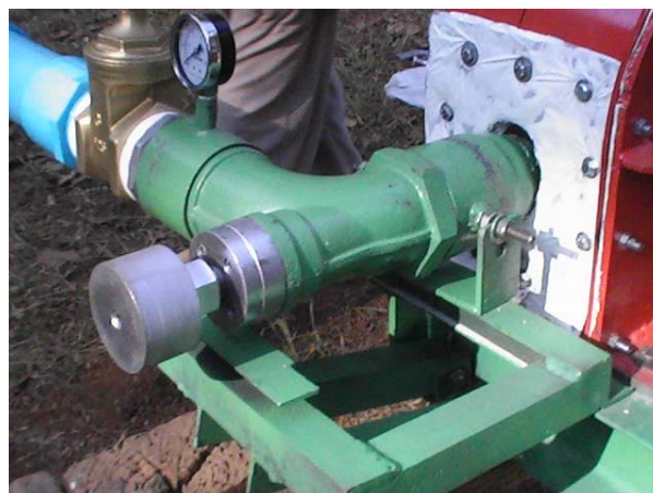
รูปที่ 84 หัวฉีดออกแบบให้ปรับอัตราการไหลของน้ำได้อย่างละเอียด
