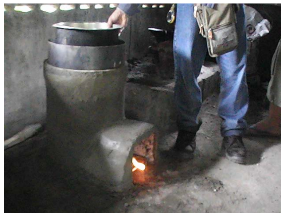
รูปที่ 188 การจุดไม้ที่ปราศจากควันของระบบเตาที่ออกแบบให้มีความปลอดภัยและไม่เกิดควันเผาไหม้
