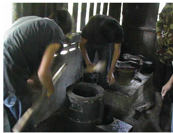
รูปที่ 180 หลังจากใส่วัสดุทำตัวเตาอัดแน่นลงในแม่แบบโลหะ
