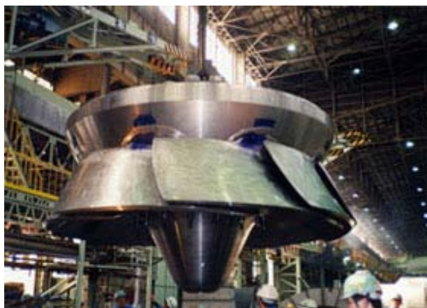
รูปที่ 10 แสดงตัวอย่างกังหันน้ำเคเรียว ที่มา (Mitsubishi Heavy Industries Ltd. 2003. On-line)
