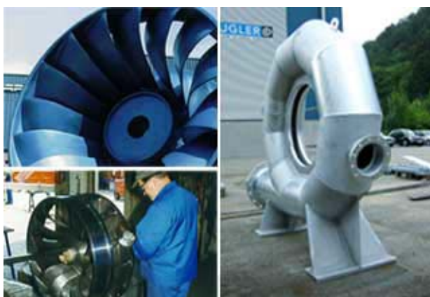
รูปที่ 8 แสดงตัวอย่างกังหันน้ำฟรานซิส ที่มา (Hydro Energy. 2003. On-line)
