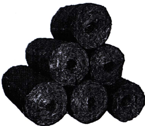
รูปที่ 4.22 ลักษณะแท่งเชื้อเพลิงรูปทรงกระบอกมีรูกลวงตรงกลาง
