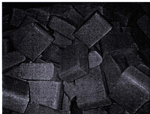
รูปที่ 4.26 แท่งเชื้อเพลิงที่ถูกอัดเป็นก้อนทรงสี่เหลี่ยมตัน
