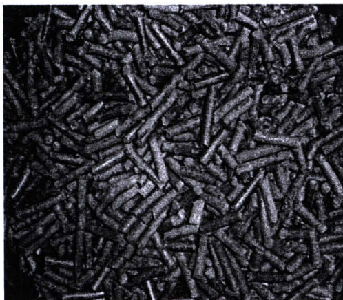
รูปที่ 4.23 ลักษณะแท่งเชื้อเพลิงรูปทรงกระบอกขนาดเล็กมีรูกลวงตรงกลาง
