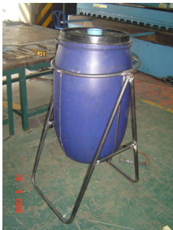
รูปที่ 11 ถังทำปุ๋ยหมักจากเศษขยะเปียกเติมอากาศ ขนาด 60 ลิตร สามารถผลิตปุ๋ยหมักโดยใช้เวลา 15 – 30 วัน
