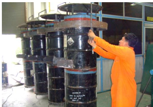
รูปที่ 11 ถังทำปุ๋ยหมักจากเศษขยะเปียกเติมอากาศ ขนาด 60 ลิตร สามารถผลิตปุ๋ยหมักโดยใช้เวลา 15 – 30 วัน
