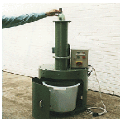
รูปที่ 14 เครื่องย่อยแก้ว ขนาด 50 ลิตร สามารถย่อย ผสมขวดแก้วได้ในอัตราความเร็ว 100 ลิตร ต่อ ชั่วโมง
