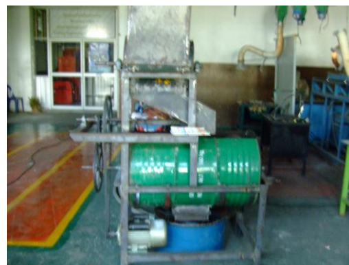
รูปที่ 13 เครื่องย่อยปุ๋ยหมักและเศษใบไม้และผสมปุ๋ย ขนาด 100 ลิตร สามารถย่อยผสม ปุ๋ยหมักและเศษใบไม้ได้ ในอัตราความเร็ว 300 ลิตร ต่อ ชั่วโมง
