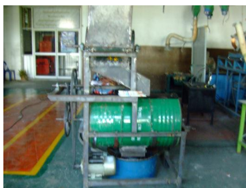
รูปที่ 44 เครื่องย่อยปุ๋ยหมักและเศษใบไม้และผสมปุ๋ยขนาด 100 ลิตร สามารถย่อยผสม ปุ๋ยหมักและเศษใบไม้ได้ในอัตราความเร็ว 300 ลิตร ต่อ ชั่วโมง
