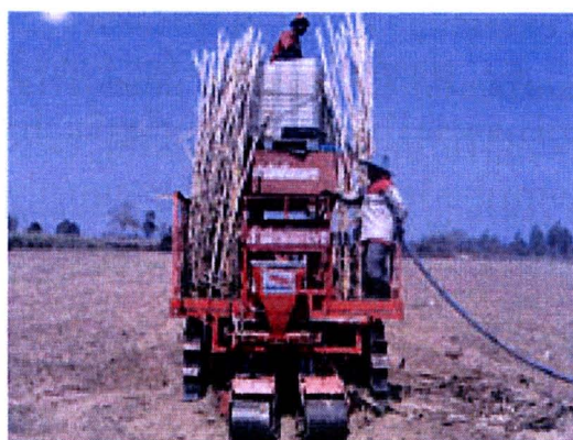
ภาพที่ 5.7 รถแทรกเตอร์ที่มีการดัดแปลงเพื่อปลูกอ้อยแบบ 1 ร่อง 4 แถว ด้วยระบบน้ำหยด
