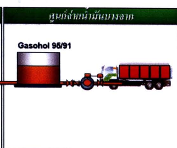
ภาพที่ 12 ระบบผสม-จ่าย ศูนย์จ่ายน้ำมันบางจาก [7]
