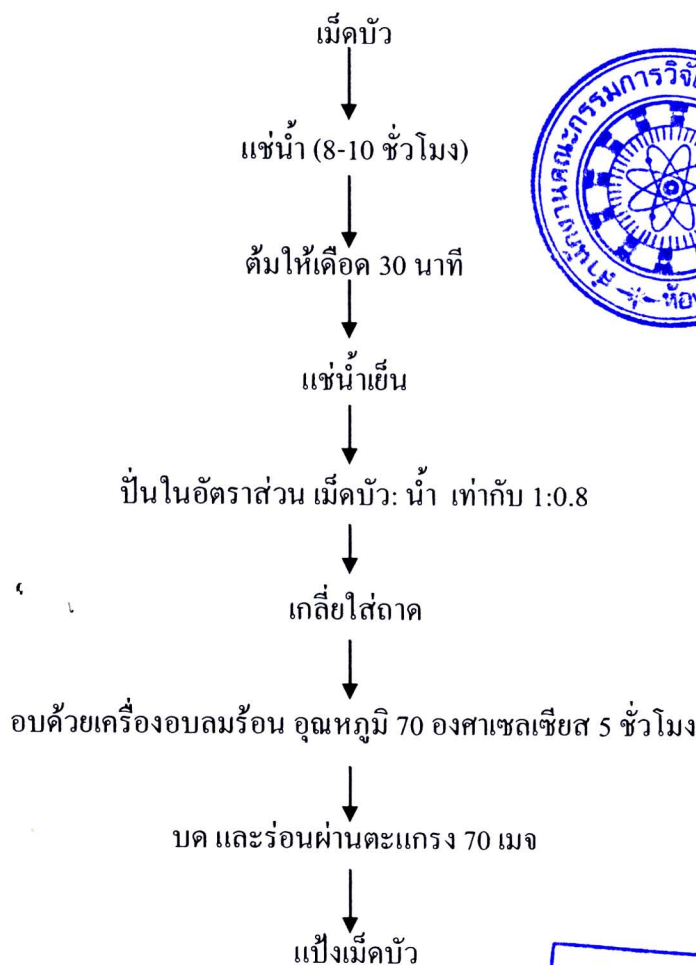
ภาพที่ 4.1 ขั้นตอนการผลิตแป้งเม็ดบัวโดยการไม่เปียก
