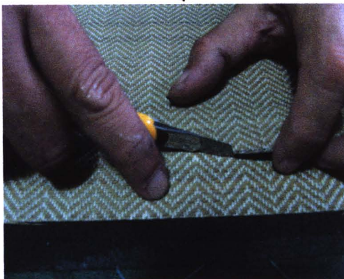
ภาพที่ 56 การตัดเสือโดยใช้กัทเตอร์ตัด
