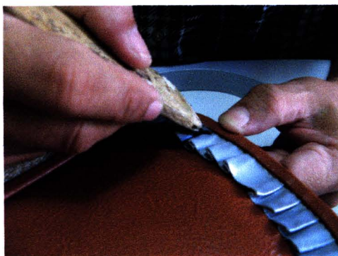
ภาพที่ 86 การเช็ดกาวโดยใช้แปรงทากาวเช็ดกาว
