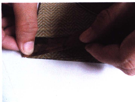
ภาพที่ 71 การประกอบหนังกับเส้นเพื่อการเย็บก้นกลับ
