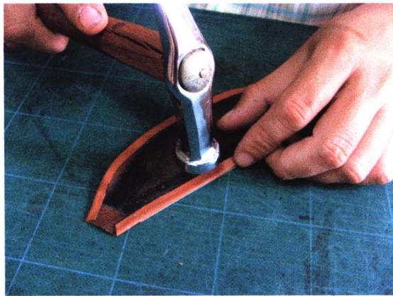
ภาพที่ 69 การพับริมเส้นตรงตามแบบจริง
