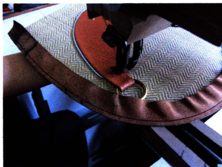
ภาพที่ 73 การเย็บจักรชิ้นส่วนด้านข้างของกระเป๋า
