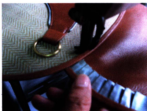
ภาพที่ 79 การประกอบรูปทรงชิ้นส่วนต่างๆ โดยการเย็บจักร
