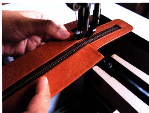
ภาพที่ 80 การเย็บจักรชิ้นจี๊ปปากกระเป๋
