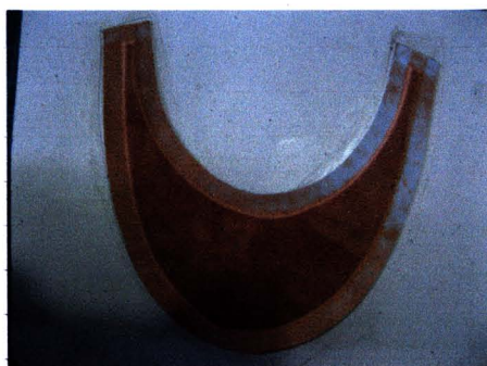
ภาพที่ 64 การทากาวโดยรอบขึ้นตักแต่งด้านข้างของกระเป๋
