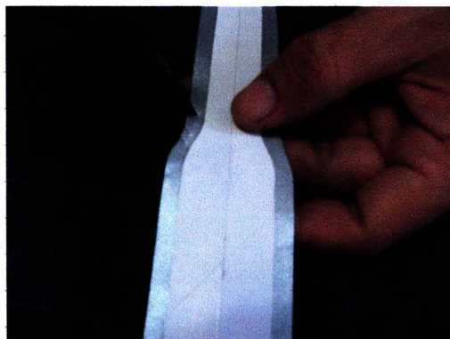
ภาพที่ 67 การชวยหนังด้วยกรรไกร เพื่อการพับริมในส่วนเว้า
