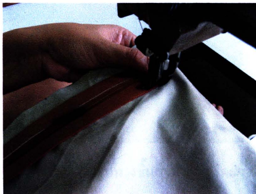
ภาพที่ 76 การเย็บจักรขึ้นส่วนซิปด้านในกระเป๋า
