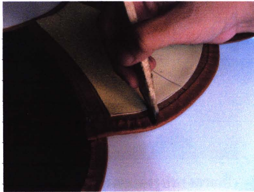
ภาพที่ 81 การทากาวเพื่อการประกอบชิ้นในปากกระเป๋า
