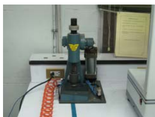
รูปที่ 3-4 แสดงการทดสอบการหาอุณหภูมิและเวลาคงรูปของยางด้วยเครื่อง Moving Die Rheometer
