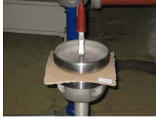
รูปที่ 3-5 แสดงการทดสอบความคงทนต่อแรงดันไฟฟ้า
