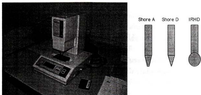
รูปที่ 2-11 แสดงเครื่องวัดความแข็งและลักษณะของหัวกดแบบต่างๆ
