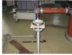
รูปที่ 3-5 แสดงการทดสอบความคงทนต่อแรงดันไฟฟ้า
