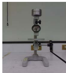
รูปที่ 3-6 แสดงเครื่องมือการทดสอบความแข็งแบบ Shore Durometer (Shore A)
