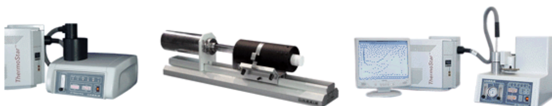
รูปที่ 2-13 แสดงเครื่องทดสอบ (Thermogravimetric Analysis ;TGA)
