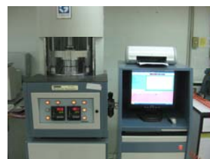
รูปที่ 3-4 แสดงการทดสอบการหาอุณหภูมิและเวลาคงรูปของยางด้วยเครื่อง Moving Die Rheometer
