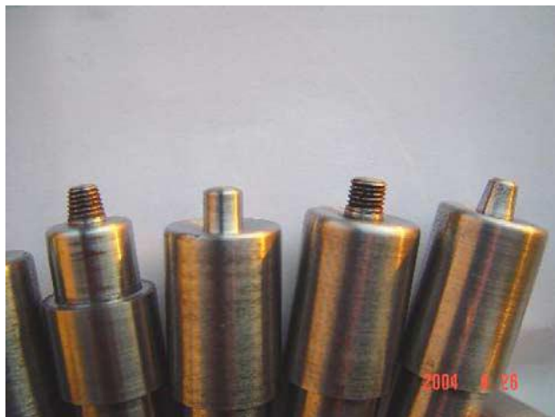
รูปที่ 2.8 เครื่องมือเชื่อมที่ออกแบบสำหรับรอยต่อชนอลูมิเนียม 2014 [20]
