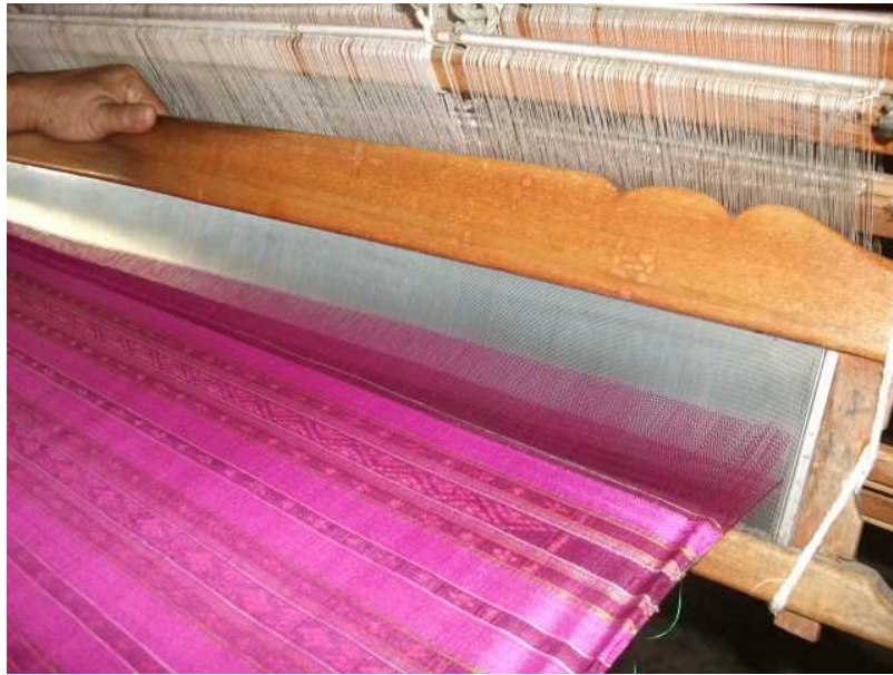
ภาพที่ 4.12 พืมที่ใช้ในปัจจุบันเป็นพืมที่ทำจากสแตนเลส
