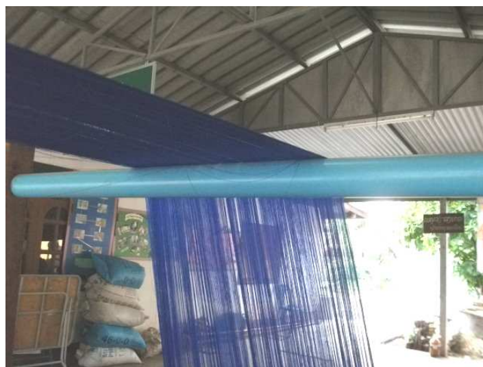
ภาพที่ 4.11 ไม้ประกอบหูกทอผ้าไหมปัจจุบันทำจากพลาสติกหรือพีวีซี
