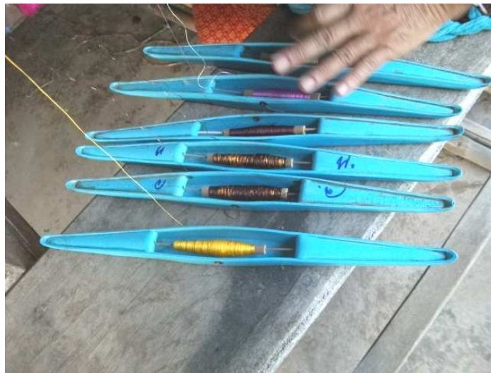
ภาพที่ 4.10 กระสวยทอผ้าไหมปัจจุบันทำจากพลาสติกหรือพีวีซี
