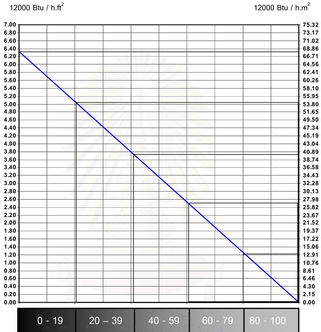
แผนภูมิที่ 4.33 (2) แบบประเมินค่าการประหยัดพลังงานสำหรับช่องเปิดอาคารในกรณีที่ช่องเปิดมีการเปิด - ปิด จากข้อมูลปี 2543
