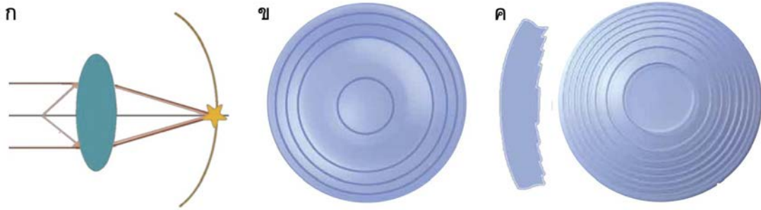
รูปที่ 21. แสดงลักษณะของเลนส์ตาเทียมชนิดหลายระยะ ก. เมื่อแสงเดินทางผ่านเลนส์ชนิดดังกล่าว ตัวเลนส์จะทำการปรับแสงให้ไปตกที่จอประสาทตา ข. เลนส์ชนิด refractive IOL จะมีค่าสายตาที่แตกต่างกันในแต่ละวงแหวนของเลนส์ และ ค. เลนส์ชนิด diffractive IOL จะมีการสร้างวงแหวนที่มีลักษณะเป็นขั้น ๆ ขึ้นมาซึ่งจะช่วยกระจายแสงให้ไปตกในตำแหน่งที่แตกต่างกัน
