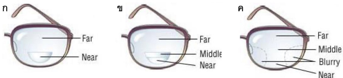
รูปที่ 18. แสดงลักษณะของเลนส์ประกอบแว่นที่ช่วยในการมองหลายระยะ ก. แสดงลักษณะเลนส์ที่มี 2 ระยะ (ระยะปกติ และระยะใกล้) ข. แสดงลักษณะเลนส์ที่มี 3 ระยะ (ระยะปกติ, ระยะกลาง และระยะใกล้) และ ค. แสดงลักษณะเลนส์หลายชั้นแบบไร้รอยต่อ
