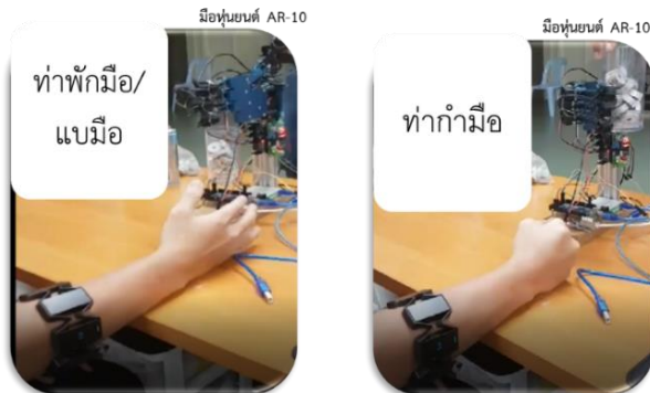
รูปที่ 11 การทำงานของมือหุ่นยนต์ผ่านการควบคุมด้วยสัญญาณไฟฟ้ากล้ามเนื้อ
