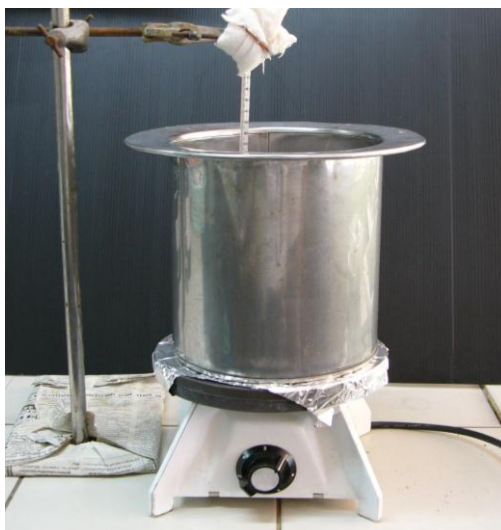
รูปที่ 3.1 อุปกรณ์ที่ใช้ในการเคี่ยวน้ำตาลมะพร้าว
