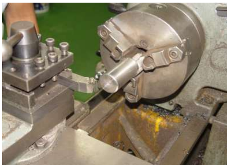
รูปที่ 3.11 การขึ้นรูปเครื่องมือเชื่อมด้วยการกลึง
