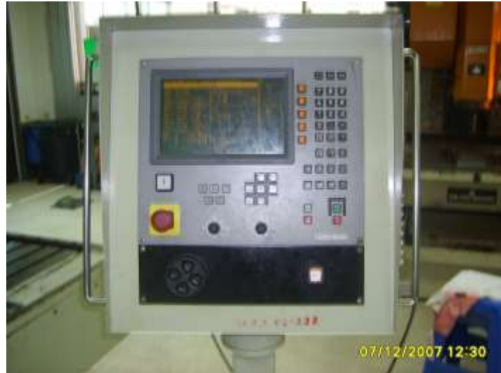
รูปที่ 3.12 แผงควบคุมของเครื่อง NC Milling [22]
