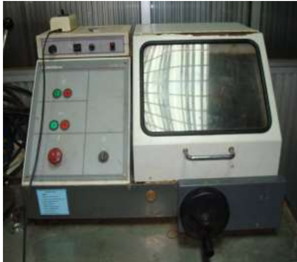
รูปที่ 3.9 เครื่องตัดชิ้นงานตรวจสอบโครงสร้างทางจุลภาค
