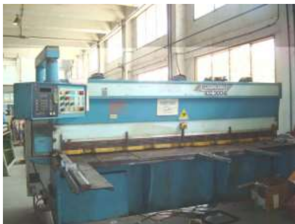
รูปที่ 3.6 เครื่องตัดแผ่นโลหะ
