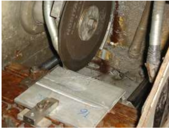
รูปที่ 3.17 การตัดอลูมิเนียม
