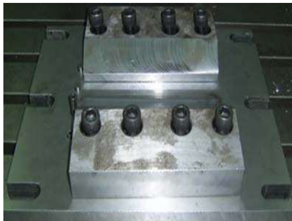
รูปที่ 3.5 อุปกรณ์จับยึด
