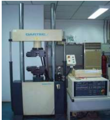
รูปที่ 3.10 เครื่องทดสอบความต้านทานแรงดึง
