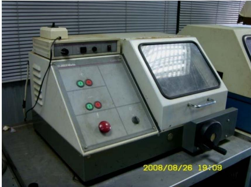
รูปที่ 3.10 เครื่องตัดชิ้นทดสอบหล่อเย็นด้วยน้ำ
