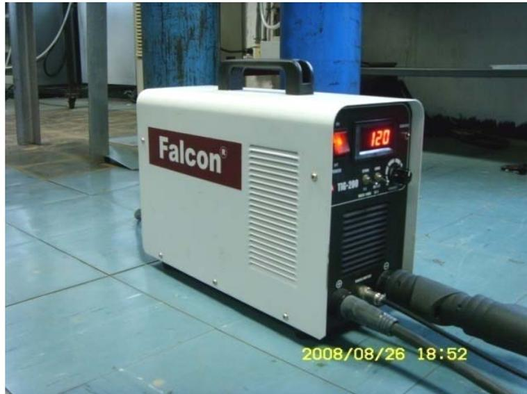
รูปที่ 3.3 เครื่องเชื่อมอาร์คแบบอินเวอร์เตอร์
