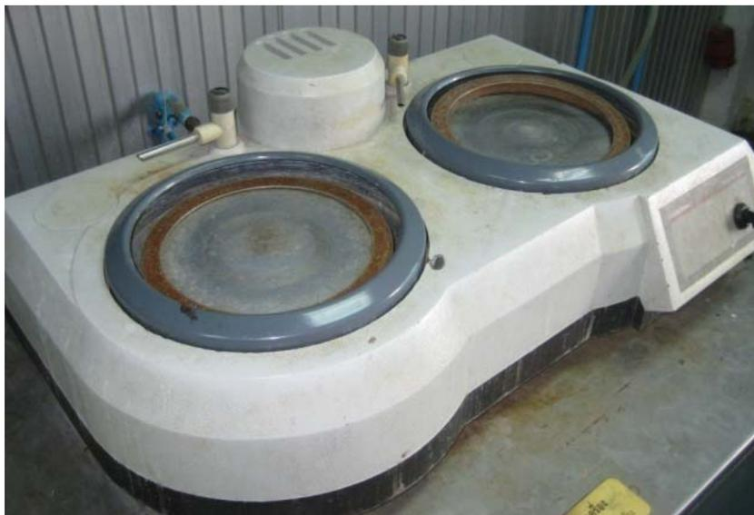
รูปที่ 3.12 เครื่องขัดดูโครงสร้าง
