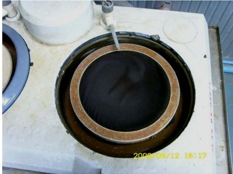
รูปที่ 3.13 ผ้าสักหลาดที่ใช้ขัดชิ้นงานด้วยผงเพชร
