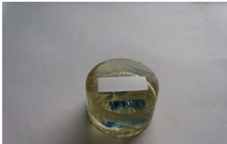
รูปที่ 3.11 ลักษณะชิ้นทดสอบหลังจากหล่อตัวเรือน
