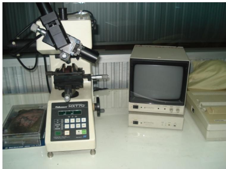
รูปที่ 3.16 เครื่องทดสอบความแข็งแบบวิกเกอร์ส
