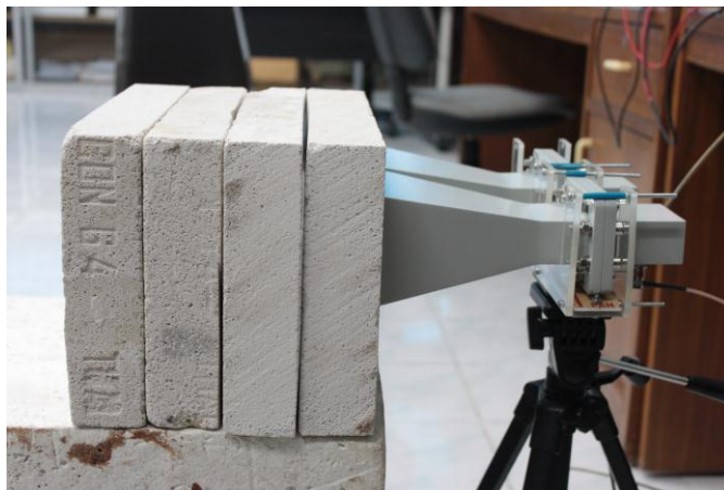
รูปที่ 3.17 การทดสอบระบบตรวจหาโลหะในคอนกรีต
