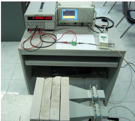
รูปที่ 3.9 ระบบตรวจหาโลหะในคอนกรีต
