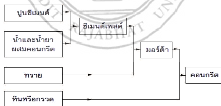
ภาพที่ 2.4 องค์ประกอบของคอนกรีต
