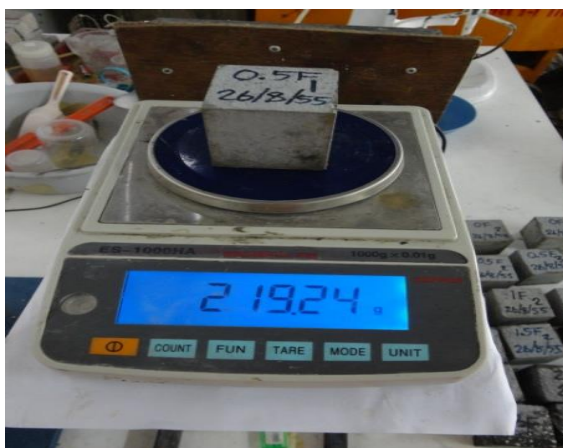
ภาพที่ 3.4 การชั่งชิ้นงานสำหรับการหาค่าความหนาแน่น
