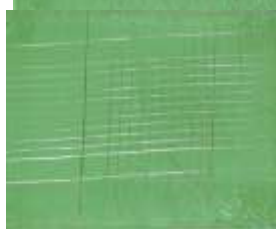
รูปที่ 64 ผิวพอลิเมอร์เคลือบที่ผ่านการทดสอบการยึดเกาะบนโลหะ
