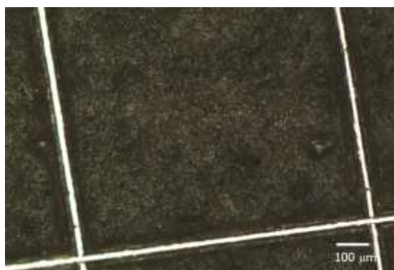
รูปที่ 65 ผิวพอลิเมอร์เคลือบที่ผ่านการทดสอบการยึดเกาะบนโลหะจาก Optical Microscope
