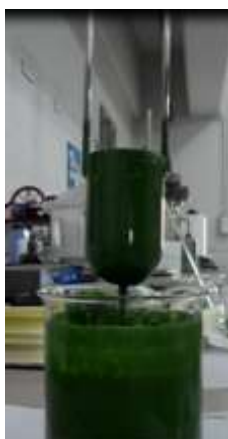
รูปที่ 56 การทดสอบความหนืดด้วย Zahn cup
