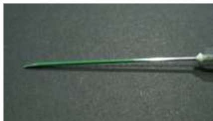
รูปที่ 48 เข็มฉีดยาที่เตรียมผิวด้วยกระดาษทราย
