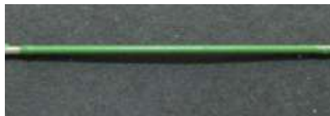
รูปที่ 50 ผิวพอลิเมอร์เคลือบบนตัวเข็มฉีดยาที่ผ่านการอบ
