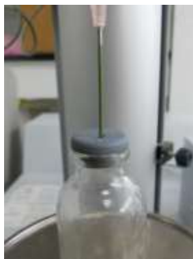
รูปที่ 70 Rubber stopper ที่ใช้วัดแรงเสียดทาน
