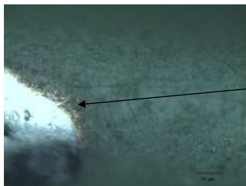
รูปที่ 35 รอยต่อของปลายเชื่อมและผิวพอลิเมอร์กำลังขยาย 20x
