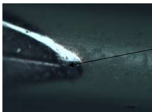
รูปที่ 34 รอยต่อของปลายเชื่อมและผิวพอลิเมอร์กำลังขยาย 10x
