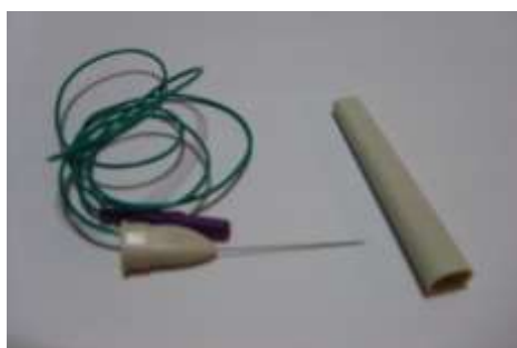
รูปที่ 32 EMG Injection Needle Electrodes
