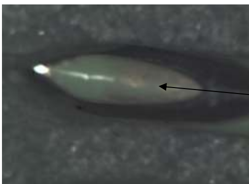
รูปที่ 33 ปลายเชื่อมโลหะกำลังขยาย 5X
