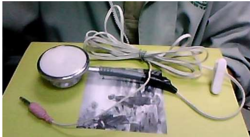
รูปที่ 4.1 Stethoscope ที่ดัดแปลง
