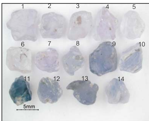
รูปที่ 112 เปรียบเทียบตัวอย่างแซปไฟร์กลุ่มสีฟ้าอ่อน แหล่ง Ilakaka ก่อนเผา (ก.) และหลังเผา (ข.) ด้วยเตาน้ำมัน (1,546 °C, ไม่ขึ้นอุณหภูมิสูงสุด)
