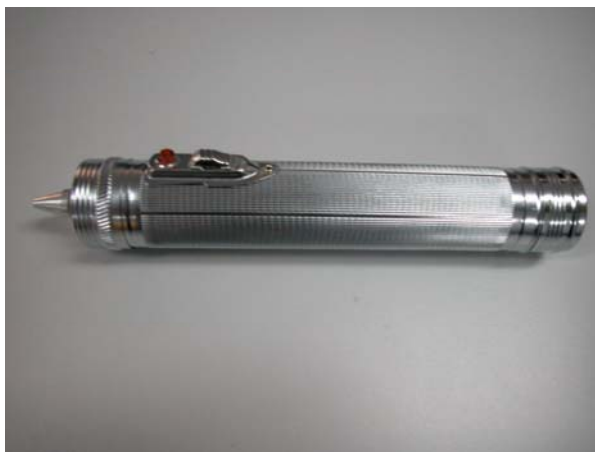
รูปที่ 213 กระบอกไฟฉายสำหรับส่องดูภายในเนื้อพลอย
