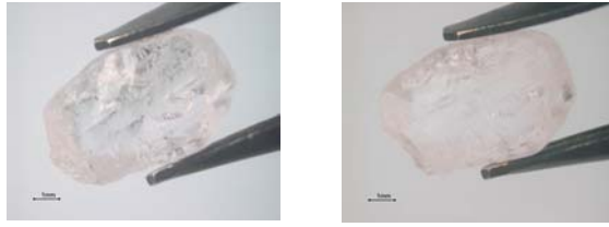
รูปที่ 161 เปรียบเทียบตัวอย่างแซปไฟร์ แหล่ง Ilakaka รหัส Ilk 2-3-007 ก่อนเผา (ซ้าย) และหลังเผา (ขวา) ด้วยเตาแก๊ส (1,900 °C, ยืนอุณหภูมิสูงสุด 5 ชั่วโมง)
