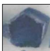
รูปที่ 113 เปรียบเทียบตัวอย่างแซปไฟร์สีน้ำเงิน แหล่ง Andranondambo ก่อนเผา (ซ้าย) และหลังเผา (ขวา) ด้วยเตาน้ำมัน (1,450 °C, ไม่ขึ้นอุณหภูมิสูงสุด)
