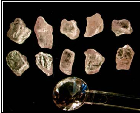
รูปที่ 95 เปรียบเทียบสีของแซปไฟร์สีม่วงดอกมะเขือจากแหล่ง Ilakaka ก่อนเผา(ซ้าย) และหลังเผา(ขวา)
