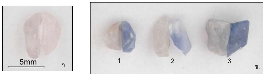
รูปที่ 122 เปรียบเทียบตัวอย่างแซปไฟร์แหล่ง Ilakaka ก่อนเผา (ซ้าย) และหลังเผา (ขวา) ด้วยเตาน้ำมัน ( 1,582^{\circ}\text{C} , ไม่เย็นอุณหภูมิสูงสุด) [รูป ก. หมาอ่อน และ รูป ข. หมาป็นหิน]
