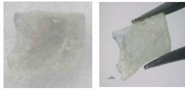
รูปที่ 155 เปรียบเทียบตัวอย่างแซปไฟร์ กลุ่มสีเขียว แหล่ง Ilakaka รหัส Ilk 2-5-013 ก่อนเผา (ซ้าย) และหลังเผา (ขวา) ด้วยเตาแก๊ส ( 1,860^{\circ}\text{C} , ยืนอุณหภูมิสูงสุด 2 ชั่วโมง)
