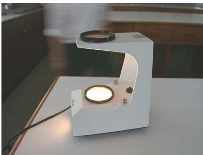
รูปที่ 30 เครื่องโพลาไรสโคป (polariscope) ใช้ตรวจหาทิศทางของแกนแสงของพลอย
