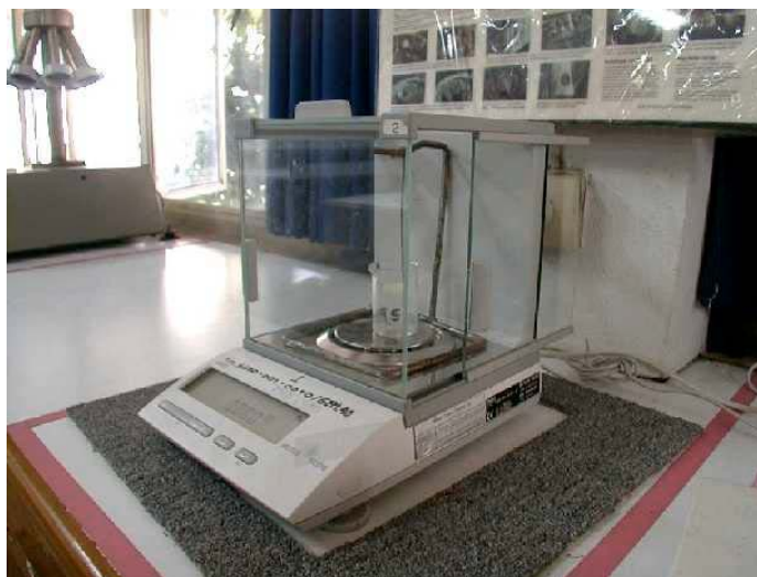
รูปที่ 6 เครื่องชั่งละเอียด (hydrostatic balance) สำหรับชั่งน้ำหนักและหาค่าความถ่วงจำเพาะของพลอย
