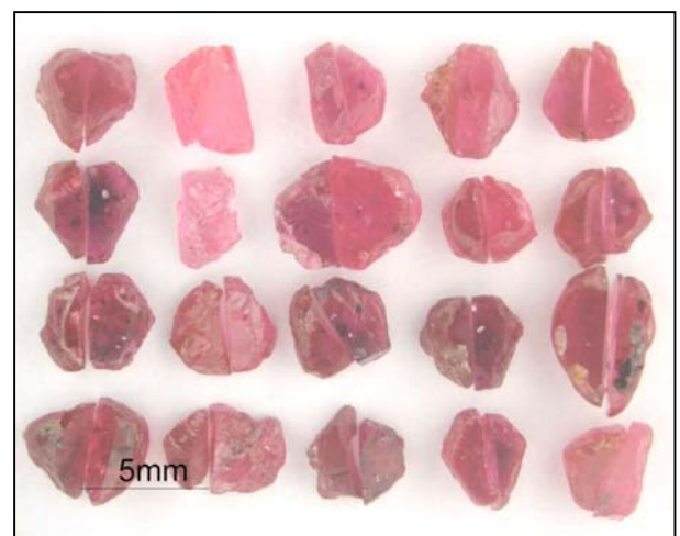
รูปที่ 96 ตัวอย่างทับทิมแหล่ง Andilamena (กลุ่ม A) หลังการเผาครั้งที่ 1 (รูป ก.) ครั้งที่ 2 (รูป ข.) และครั้งที่ 3 (รูป ค.) โดยเปรียบเทียบตัวอย่างก่อนเผา (ตัวอย่างซีกซ้ายมือ) และหลังเผา (ตัวอย่างซีกขวามือ)
