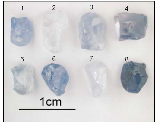
รูปที่ 111 เปรียบเทียบตัวอย่างแซปไฟร์กลุ่มสีน้ำเงิน แหล่ง Ilakaka ก่อนเผา (ก.) และหลังเผา (ข.) ด้วยเตาน้ำมัน (1,500 °C, ไม่ขึ้นอุณหภูมิสูงสุด)
