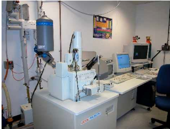
รูปที่ 39 เครื่อง scanning electron microscope with energy dispersive X-ray fluorescence (JEOL Model : JSM-5900LV)
