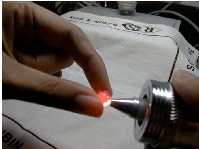
รูปที่ 12 การส่องดูเนื้อพลอยด้วยกระบอกไฟฉายสำหรับส่องพลอย
