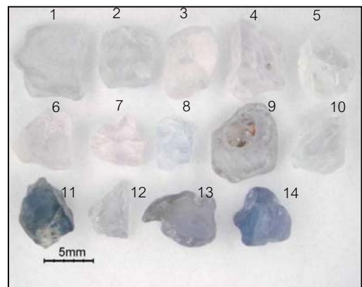
รูปที่ 112 เปรียบเทียบตัวอย่างแซปไฟร์กลุ่มสีฟ้าอ่อน แหล่ง Ilakaka ก่อนเผา (ก.) และหลังเผา (ข.) ด้วยเตาน้ำมัน (1,546 °C, ไม่ขึ้นอุณหภูมิสูงสุด)
