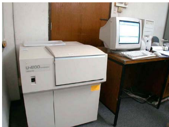
รูปที่ 31 เครื่อง UV-Vis-NIR spectrophotometer ของ HITACHI รุ่น U-4100
