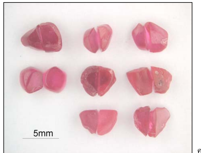
รูปที่ 97 ตัวอย่างทับทิมแหล่ง Vatomandry (กลุ่ม A) หลังการเผาครั้งที่ 1 (รูป ก.) ครั้งที่ 2 (รูป ข.) และครั้งที่ 3 (รูป ค.) โดยเปรียบเทียบตัวอย่างก่อนเผา (ตัวอย่างซีกซ้ายมือ) และหลังเผา (ตัวอย่างซีกขวามือ)
