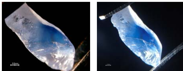
รูปที่ 138 เปรียบเทียบแซปไฟร์แหล่ง Ilakaka กลุ่มหมาปนหิน รหัส Ilk 1-4-002 ก่อนเผา (ซ้าย) และหลังเผา (ขวา) ด้วยเตาน้ำมัน (1,610 °C, ไม่เย็นอุณหภูมิสูงสุด)
