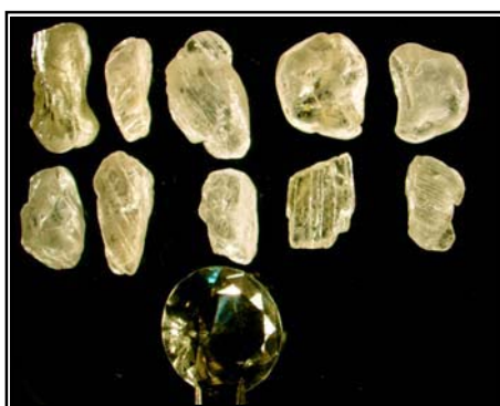
รูปที่ 90 เปรียบเทียบสีของแซปไฟร์สีเหลือง จากแหล่ง Ilakaka ก่อนเผา (ซ้าย) และหลังเผา (ขวา)
