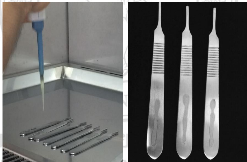
รูปที่ 3.3 แสดงขั้นตอนการใส่เชื้อแบคทีเรียบนผ้ามีดภายในตู้ปลอดเชื้อ (ซ้าย) และผ้ามีดผ่าตัดที่ผ่านกระบวนการใส่เชื้อแล้ว (ขวา)
