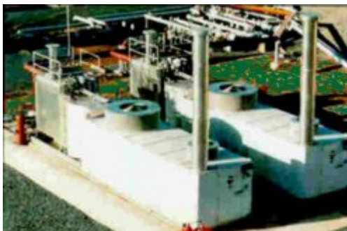
ภาพที่ 6 หน่วยควบแน่นไอระเหยน้ำมันโดยใช้ความเย็น
