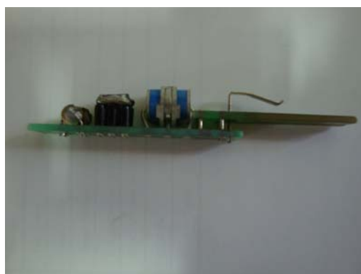
ภาพผนวกที่ 9 ตัวป้องกันเล็กร์จสำหรับสายโทรศัพท์แบบผสม
