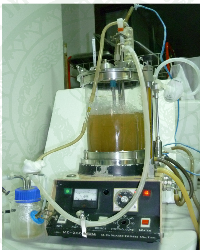
ภาพที่ 4 การผลิตเอนไซม์คาร์บอกซีเมทิลเซลลูเลสจาก T. fusca PA 1-1 ในถังหมักขนาด 2.5 ลิตร (MD-250, Marubishi, Japan)
