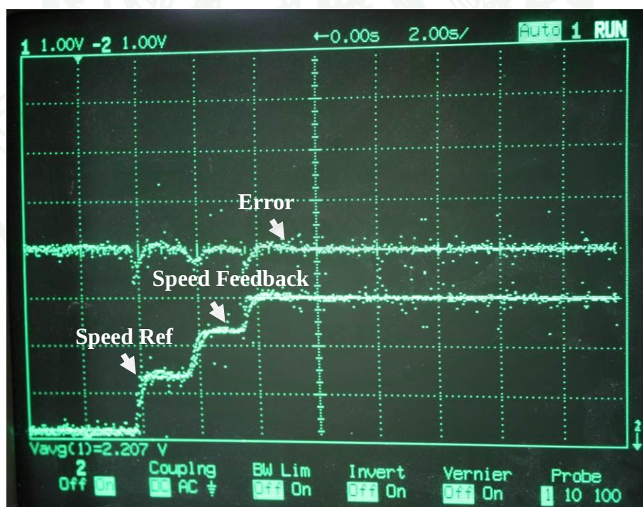
ภาพที่ 43 กราฟแสดงการติดตามสัญญาณอ้างอิงที่ความเร็วรอบ 1400, 2200 และ 3000 RPM
