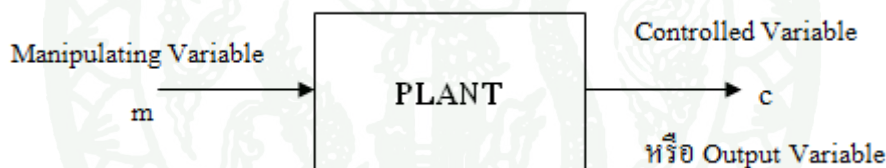
ภาพที่ 9 สัญญาณเข้าและออกของ Plant
