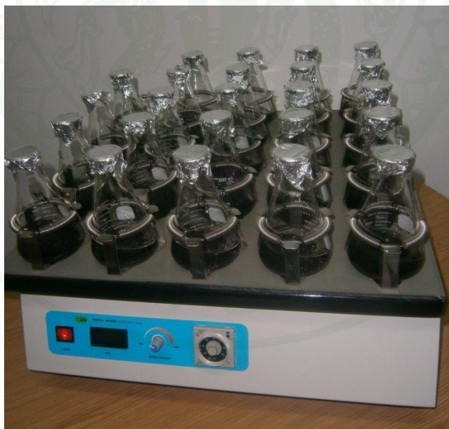
ภาพที่ 22 เครื่องเขย่าที่ใช้ในการศึกษาปัจจัยที่มีผลต่อการดูดซับแอมโมเนีย
