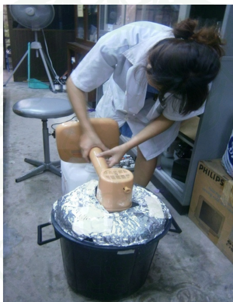
ภาพที่ 26 การศึกษาการประยุกต์ใช้งานจริงโดยการปั่นกวนด้วยใบพัดที่ต่อเข้ากับมอเตอร์พัดลม
