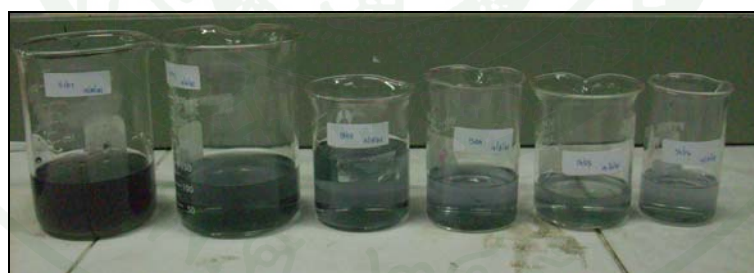
ภาพผนวกที่ ข3 ตัวอย่างน้ำเสียที่ผ่านการบำบัดด้วยอะลูมิเนียมซัลเฟต
