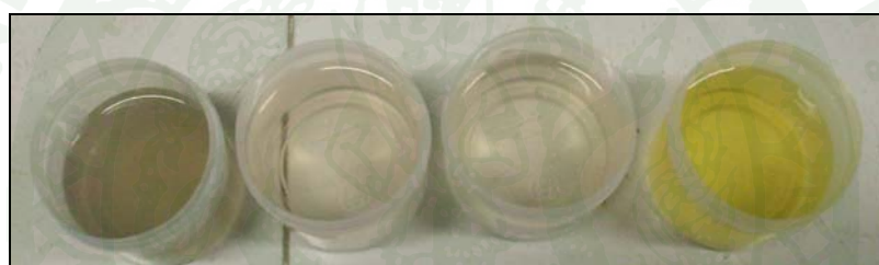
ภาพผนวกที่ ข4 ตัวอย่างน้ำเสียที่ผ่านการบำบัดด้วยโพลีอะลูมิเนียมคลอไรด์
