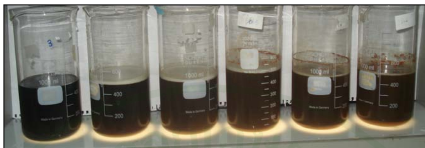
ภาพผนวกที่ ข1 ตัวอย่างน้ำเสียที่ผ่านการบำบัดด้วยเฟนตันที่ pH น้ำดิบ
